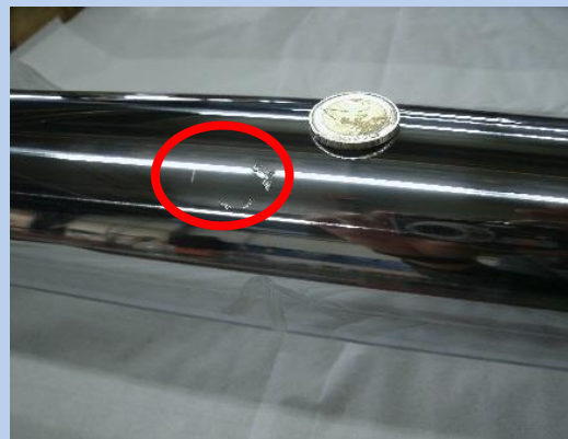
Abb. 1: Beschädigung in der Kolbenstange
