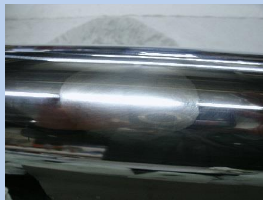
Abb. 2: Beschädigung galvanisch aufgefüllt und vorgeschliffen
