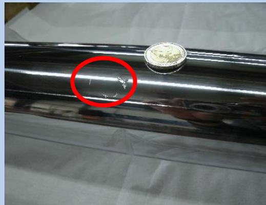
Abb. 1: Beschädigung in der Kolbenstange
