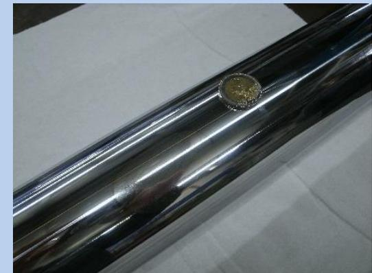
Abb. 3: Kolbenstange aufpoliert
