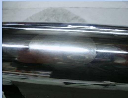
Abb. 2: Beschädigung galvanisch aufgefüllt und vorgeschliffen
